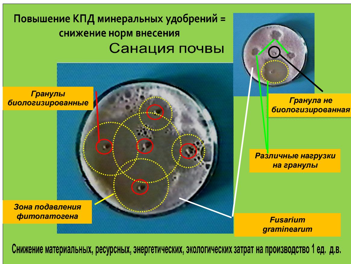
Рис. 2.1. Механизм действия бактерий на поверхность гранулы минеральных удобрений (подавление фитопатогенных микроорганизмов в почве)
